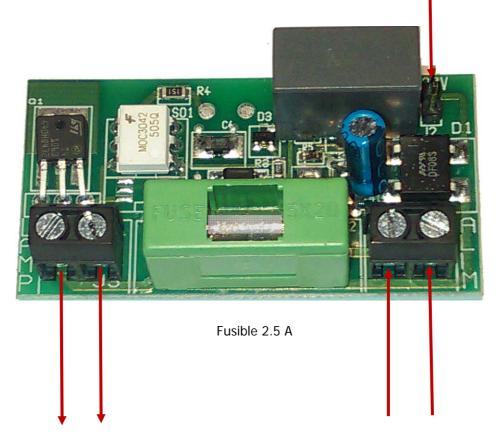
AMP : Sortie Lampe ALIM: Alimentation 24 VAC ou 230 ACV 24 VAC ou 230 VAC
