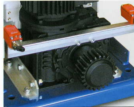
Particulier de l'engrenage d'entrainement et fins de course
