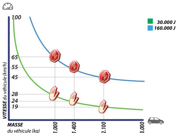
Plusieurs facteurs tels que le taux de compactage, le coefficient de perméabilité du sol et le type de béton peuvent réduire considérablement les valeurs indiquées dans le graphique.
