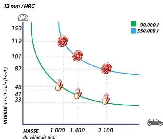
Plusieurs facteurs tels que le taux de compactage, le coefficient de perméabilité du sol et le type de béton peuvent réduire considérablement les valeurs indiquées dans le graphique.
