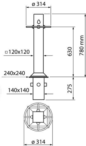
Colonne blindée anti-défoncement avec âme interne en acier renforcé et finissages extérieures en acier inox. Elle peut être enlevée de son logement avec une clé de déblocage codée.
