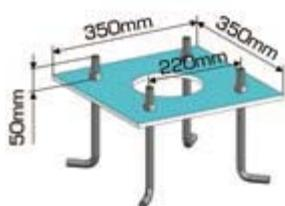
Le gabarit reste en place de niveau et doit reposer entièrement sur massif béton.
